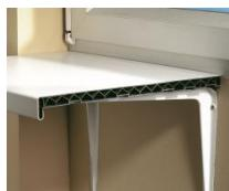
La tablette peut également être installée au moyen d'équerres. D'abord, on fixe les équerres sur le mur à la hauteur désirée. Tenez compte de la distance minimale de 10 cm par rapport à une éventuelle source de chaleur. (voir ci-dessous)
